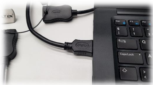
Tilkobling egen bærbar ved hjelp av HDMI-kabel
